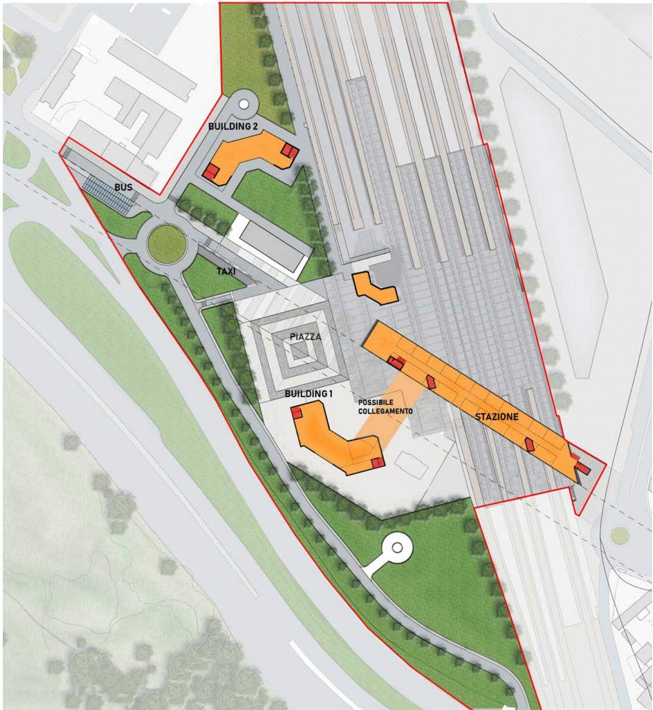
Proposta di riqualificazione architettonica e funzionale della stazione Rogoredo, pianta piano ponte.
