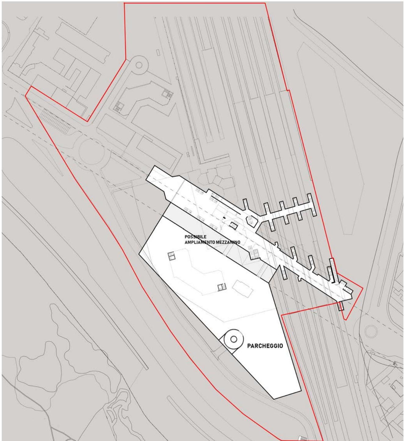
Proposta di riqualificazione architettonica e funzionale della stazione Rogoredo, pianta piano interrato.
