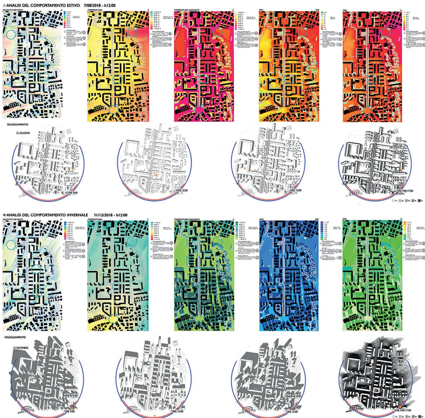
Fig. 25 - Simulazioni dei principali comportamenti bioclimatici estivi e invernali nello stato *ante operam* del quartiere ex IACP di Primavalle / *Simulations of the main summer and winter bioclimatic behaviors in the ante operam state of the ex IACP district of Primavalle* (Source: Elaboration by Research Unit Sapienza Università di Roma).
