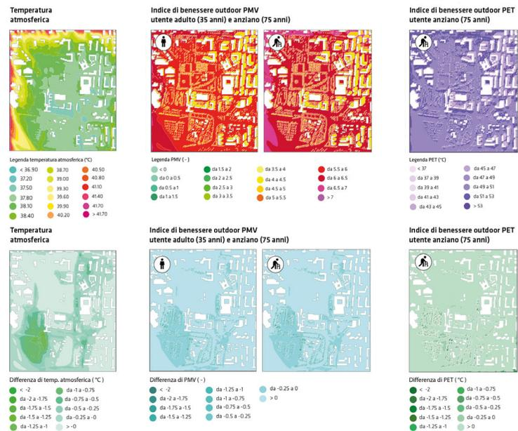
Fig. 29 - Estrapolazioni *ex post* e comparazioni degli output di temperature, PMV e PET operate sul transetto di trasformazione / Ex post extrapolation and comparison of the output of temperatures, PMV and PET indices on the development transect (Source: Authors' elaboration).
