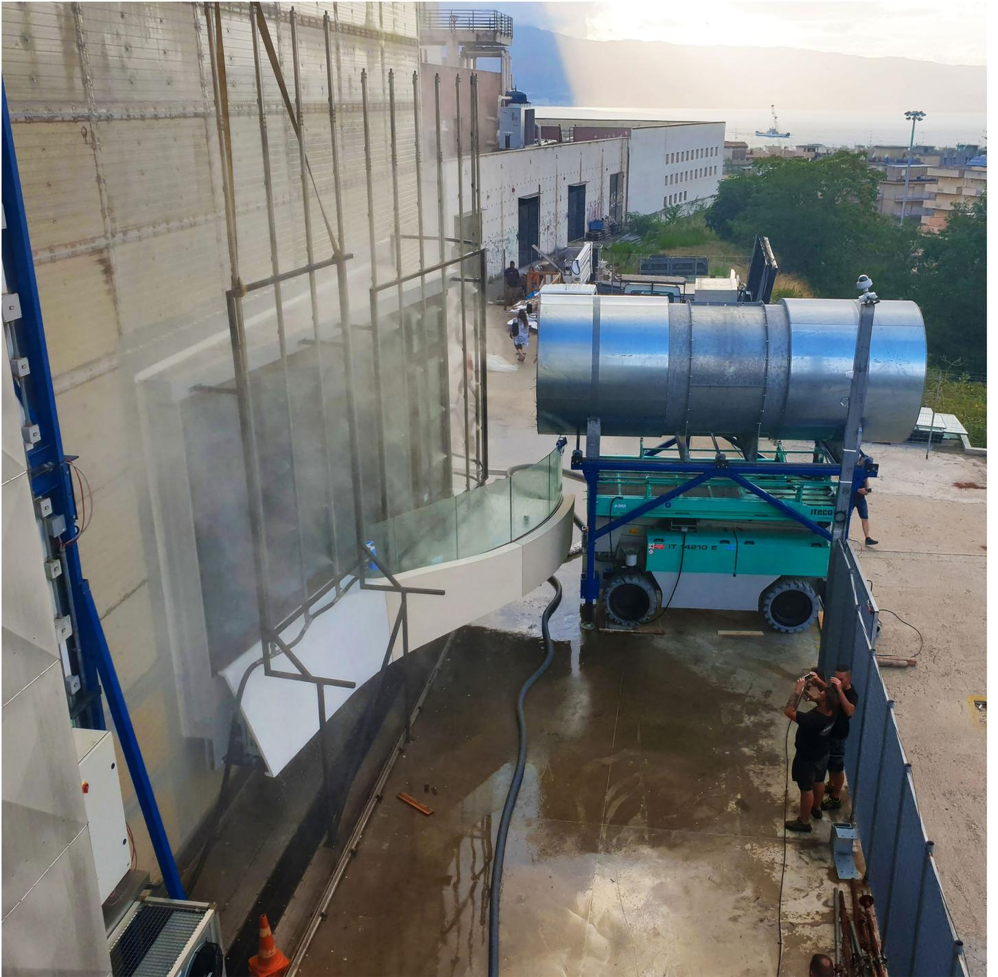
Fig. 1 - Test all'uragano di una facciata curva aggettante. Standard AAMA 501.1-5 / Hurricane test of a projecting curved facade. Standard AAMA 501.1-5. (Source: Authors' elaboration).
