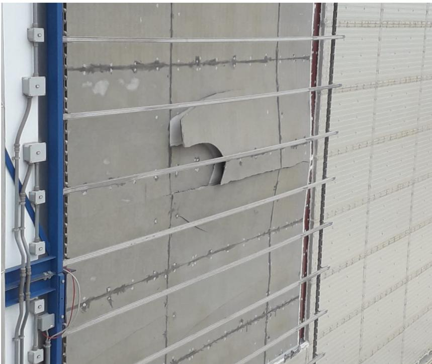
Fig. 35 - Esito simulazione di carico e pressione del vento: Rottura / *Wind load and wind pressure simulation result: Breakage* (Source: Authors' elaboration).
