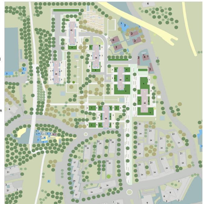
Fig. 46-47 - Planimetria dell'area di intervento di Pineto-Valle Aurelia con indicazione delle trasformazioni del trattamento materico delle superfici ante operam (in alto) e post operam (in basso) / Planimetry of the intervention area of Pineto-Valle Aurelia with indication of the transformations of the material treatment of the surfaces ante operam (top) and post operam (below) (Source: Elaboration by Research Unit Sapienza Università di Roma).
