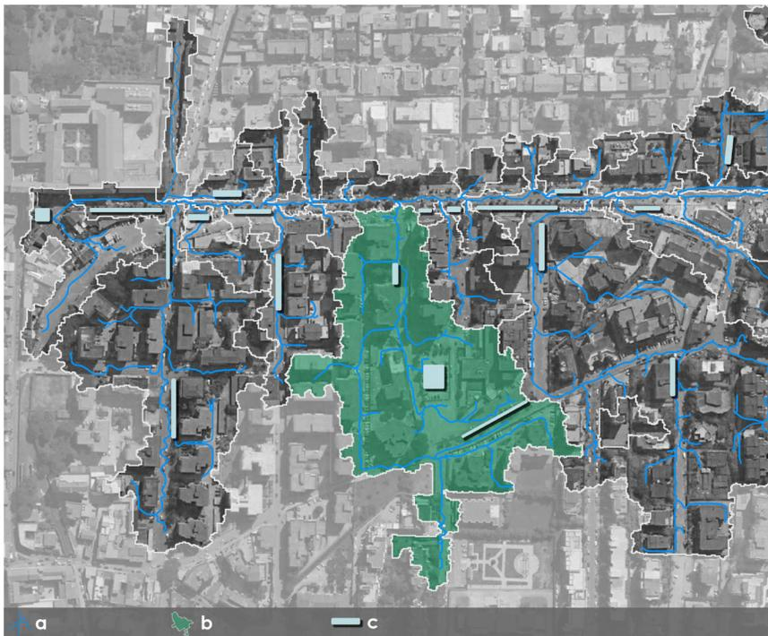
Fig. 20 - Analisi dei micro-bacini dell'area in esame: a) linee di deflusso, b) raggruppamento di aree colanti, c) fabbisogni di raccolta meteorica / *Analysis of micro-basins in the examined area: a) outflow lines, b) drainage micro-areas grouping, c) meteoric harvesting requirements* (Source: Authors' elaboration).
