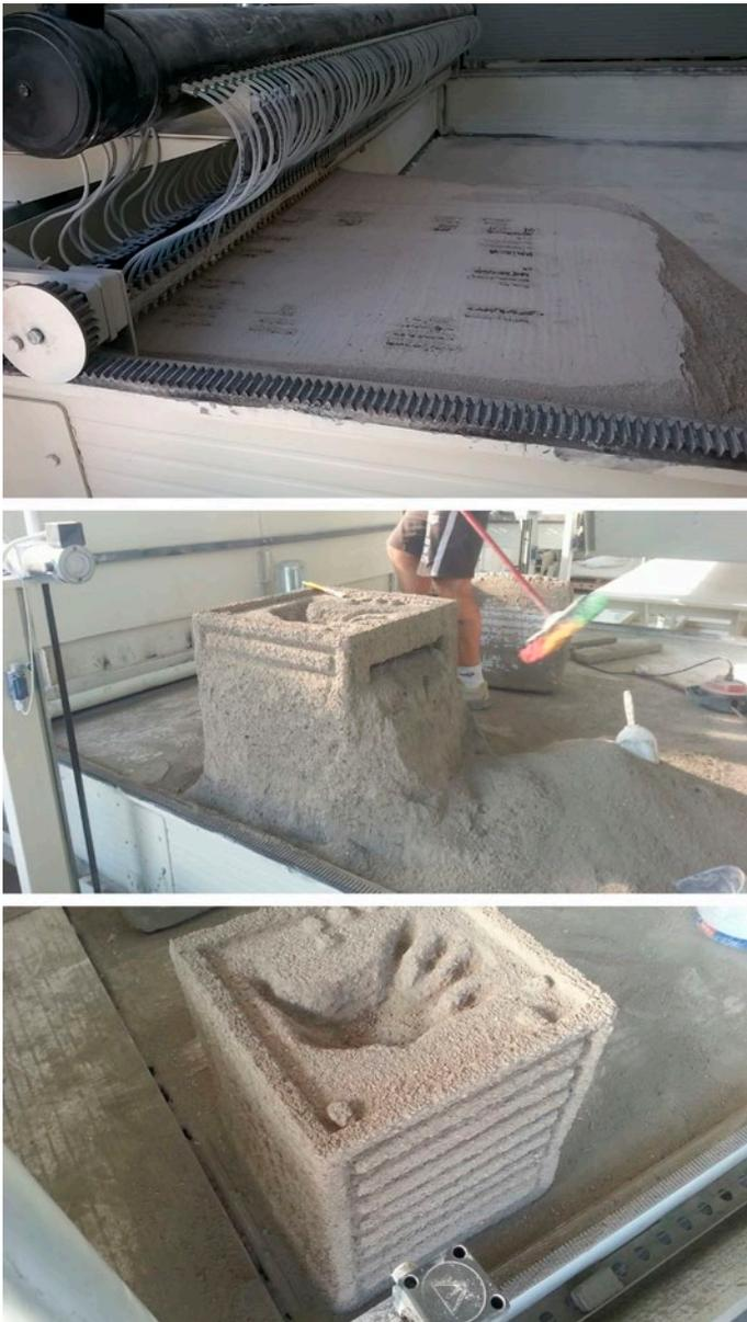
04 | Le fasi della prototipazione con stampante additiva 3D in sabbia riciclata: stampa (a), rimozione sabbia non legata (b), prototipo pronto per le rifiniture manuali (c), foto del GdL di AIP
